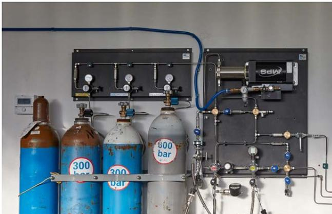
Mischpanel mit Booster (MPS).
